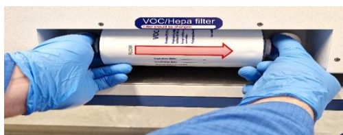
Joonis 12.2. VOC-/HEPA-filtri paigaldamise ja eemaldamise protseduur
