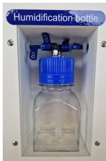
Joonis 22.1. Toru ühendus niisutuspudelil ja mitmekambrilisel kehavälise viljastamise inkubaatoril Mini MIRI® Humidity
